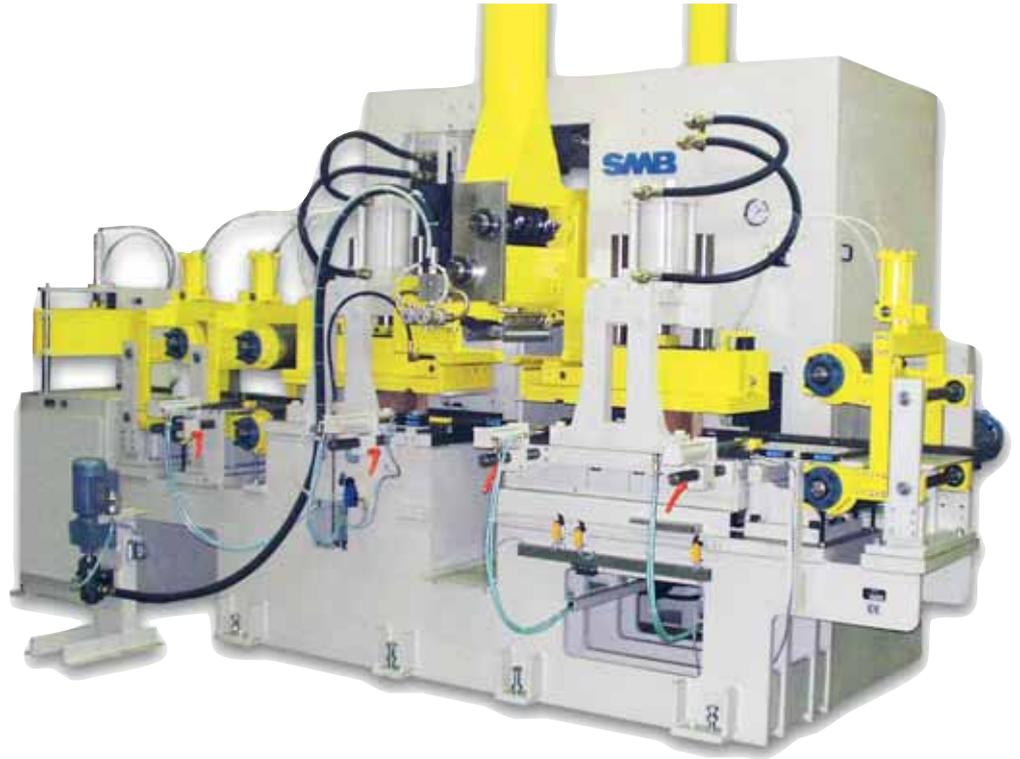
Свыше 20 лет на предприятии СМБ выпускают автоматические установки –компакт тип FLP, которые пользуются огромным успехом при изготовлении конструкционных и блочных ламелей. Рабочая величина от 6-50 тонн силой прижима позволяет производителю выбрать установку необходимой мощностью.
