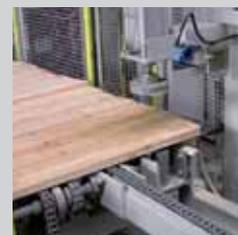
Специальные торцовочные установки, с подвижными торцовочными агрегатами или торцовочными пилами для клееного бруса, могут изготавливаться в разнообразных вариантах. Загрузка и подача на машины осуществляется посредством индивидуальных устройств.
