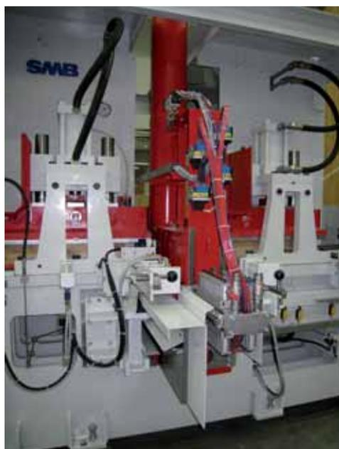
По выбору производителя возможно любое исполнение рабочей величины станка с силой прижима от 20-30 тонн. Установка оснащается также разными системами нанесения клея с применением всех возможных видов клея.
