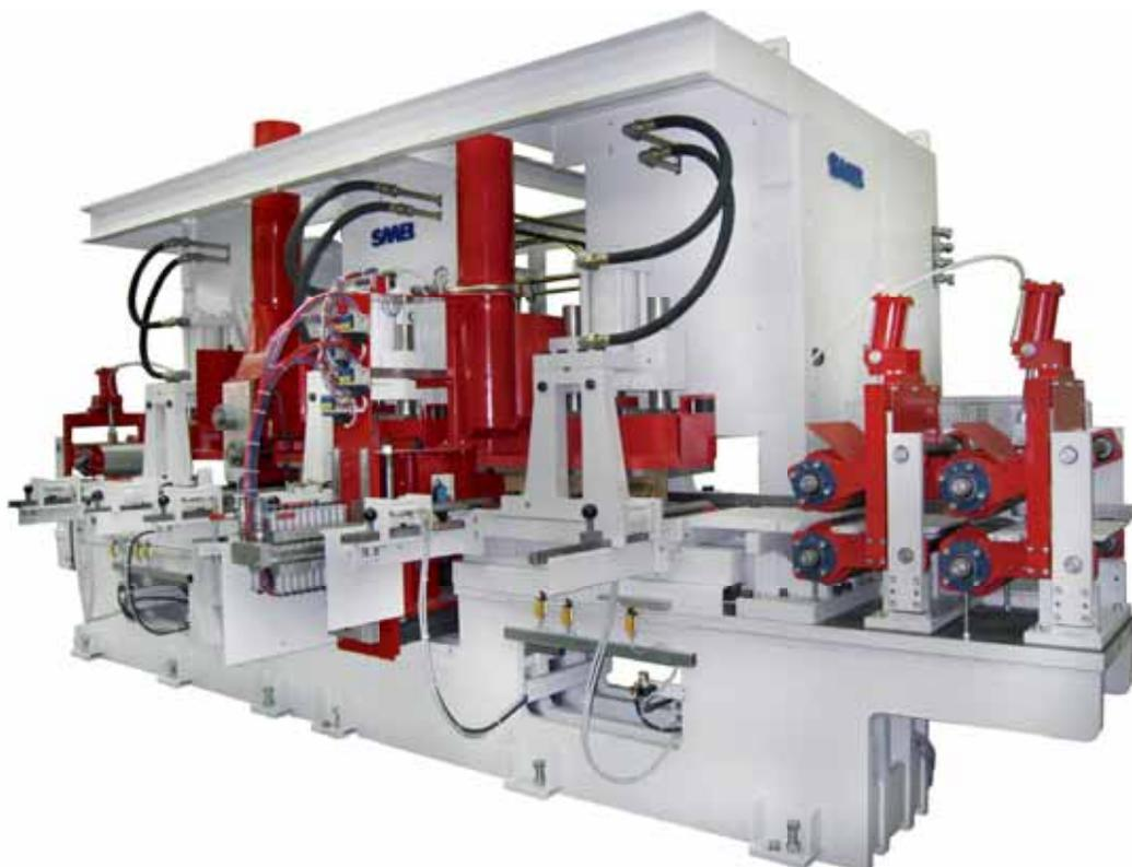
Автоматическая установка FLP 2 делает возможным вертикальное и горизонтальное сращивание на одной машине. Блочные и конструкционные ламели, а также брус для блочных домов можно производить теперь более экономично. Машина оснащена двумя фрезерными агрегатами и двумя прессами.
