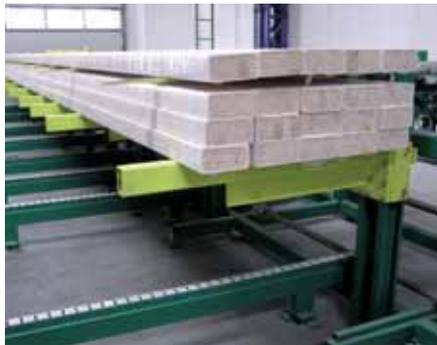
В стандартную программу СМБ включены штабелеукладчики с соответствующим поперечным положением для затверждения проклеенных заготовок. Далее применяются установки для штабелирования длинных строганных заготовок. В поставку могут быть включены упаковочные системы, которые встраиваются в любое время.
