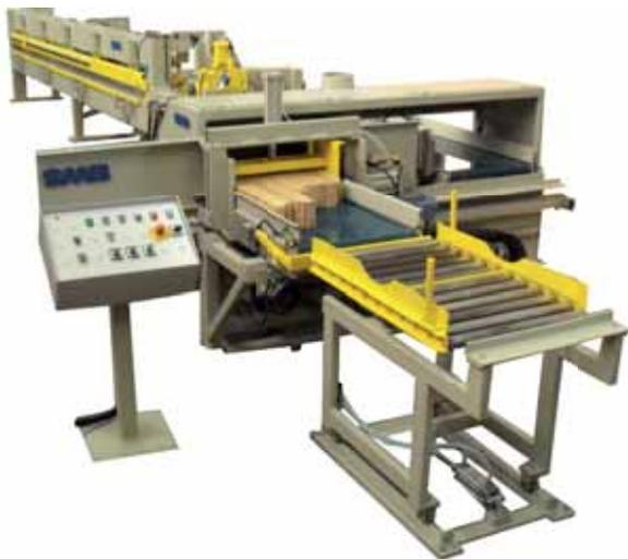
Ручной стол с вращением перед фрезерным станком. Автоматическая подача фрезы с регулируемым двигателем. Неподвижный фрезерный агрегат с подъемным шпинделем, измельчителем и фрезерным столом с перемещением, включая подачу клея. Приёмный транспортер с участком связки пакетов и дальнейшая подача к ручной сортировке заготовок, а также, автоматическая связка в лицевом прессе с торцовочной пилой.
